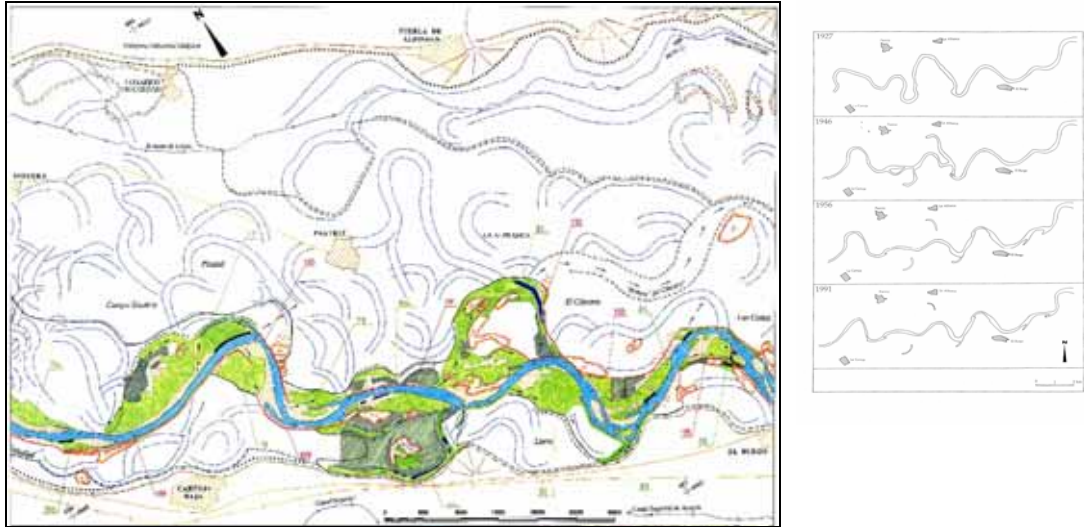
Fig. 1. Llanura de inundación, meandros abandonados y sotos del Ebro en la Reserva Natural de los Galachos, aguas abajo de Zaragoza (Ollero, 1992). A la derecha detalle del trazado del cauce en 1927, 1946, 1956 y 1991 (Ollero, 1995).
